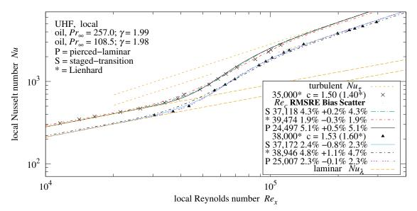
Figure 32. Žukauskas and Šlančiauskas [18] oil-critical transition.
